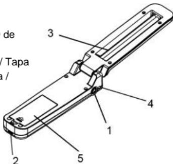
*Inserimento batterie / Batteries mounting / Insertion sde piles / Insertar baterias / Batterien einlegen / Inserir pilhas / Εισαγωγή μπαταριών*
