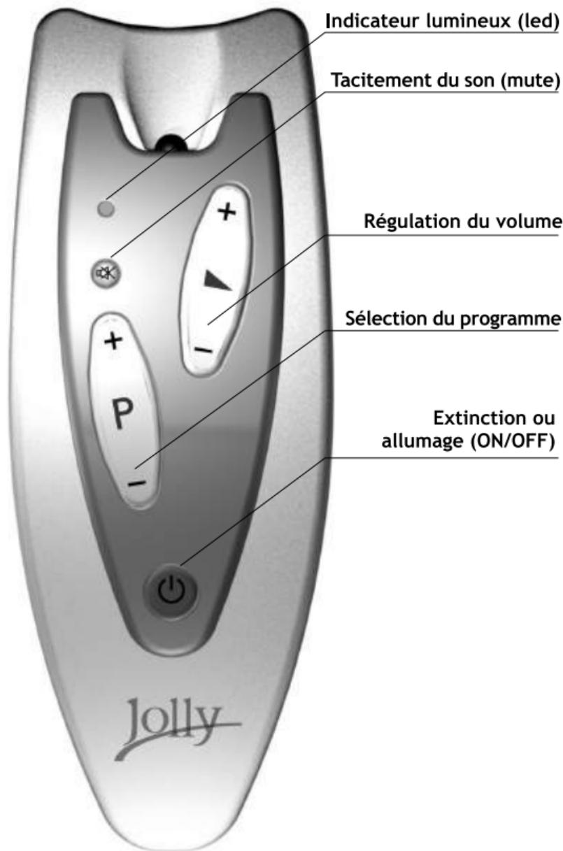
\_ Pour l'allumage poussez la touche  $\odot$ , ou P+, ou bien encore P+  $\blacktriangleleft$  + simultanément (pour certains modèles d'appareils).
