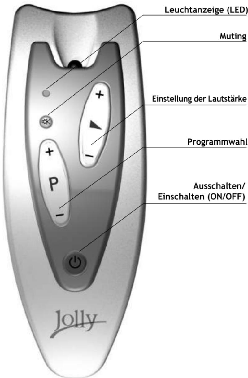
Drücken Sie zum Einschalten auf die Taste ( ) , oder auf P+ , oder gleichzeitig auf P+ und ▶+ (bei einigen Gerätemodellen).
